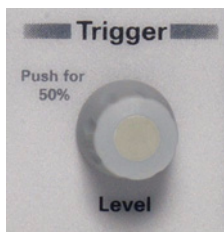
Рис. 6 Элемент управления запуском осциллографа
