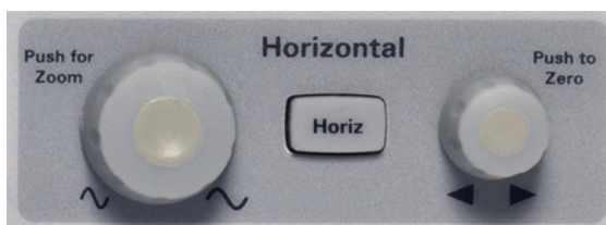
Рис. 4 Элементы управления разверткой (по оси X) осциллографа
