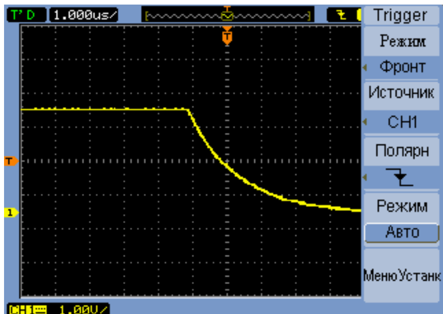
Рис. 15 Синхронизация по заднему фронту
